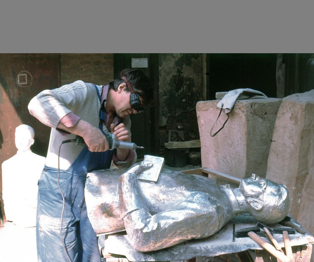
Sveukupnu površinu brončanog odljeva valja dovesti u suglasje sa sadrenim modelom.
