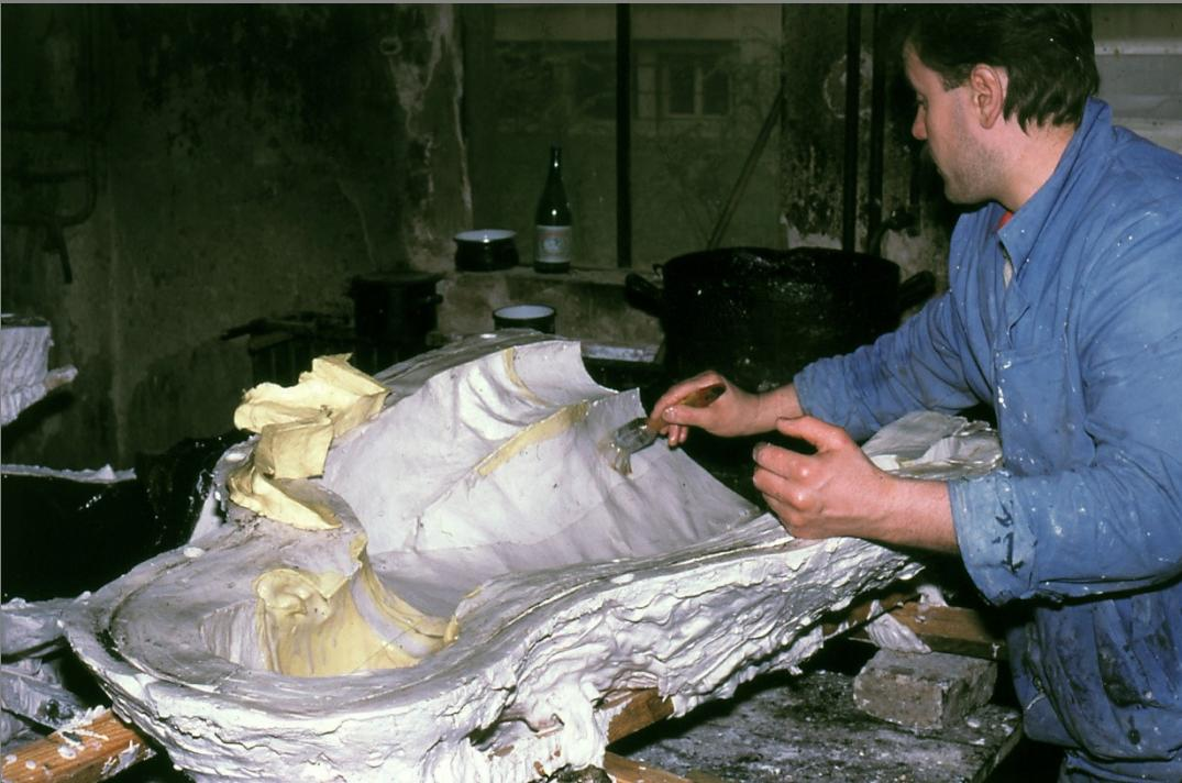
Ponovnim slaganjem dijelova kalupa u kalupnu kapu pripremljen je negativ za izradu voštanog pozitiva.
